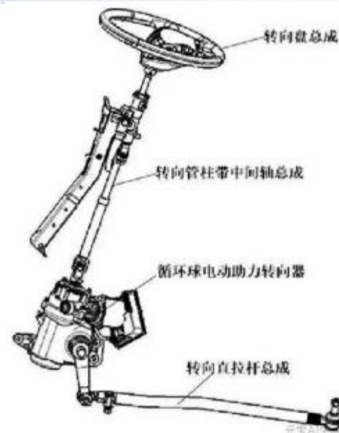
X-EPS (循环球式EPS) n 输出力矩大 n 一般用于商用车
